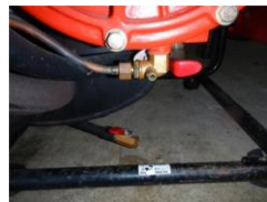
ポンプ排水バルブ
