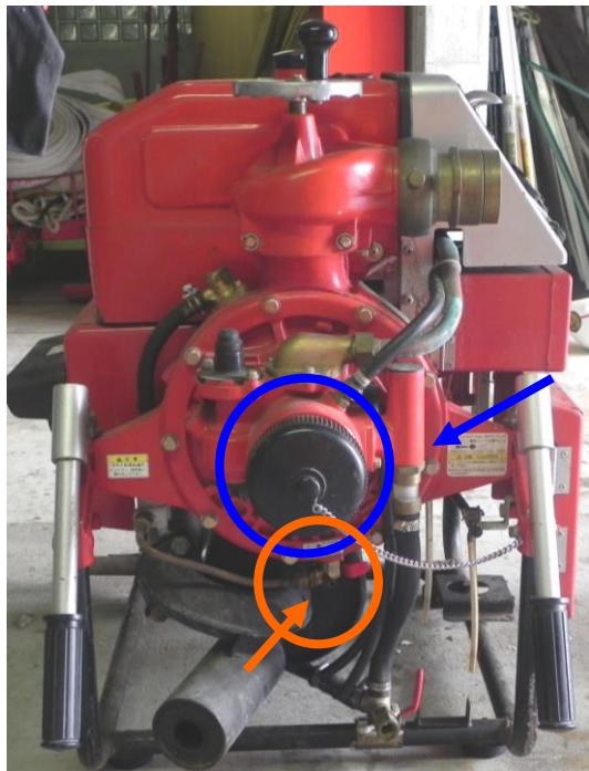
① エンジン停止状態にて、ポンプ、シリンダの排水を完全に行い、吸水口キャップを開じる。
